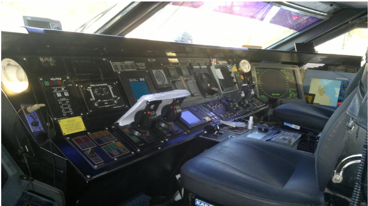
Εικόνα 4.2.1/ 1: Άποψη των θέσεων ελέγχου “CHIEF OFFICER” (Αριστερή πλευρά) και “MASTER” (Δεξιά πλευρά) στη γέφυρα του ΦΛΑΙΝΓ ΚΑΤ 4. Στην πλευρά “MASTER” διακρίνονται οι οθόνες των συσκευών RADAR και ECDIS.
