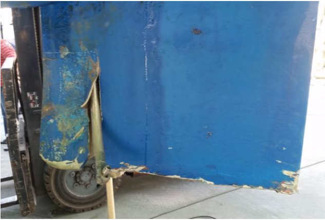
Εικόνες 3.7/ 1 & 2: Το αριστερό πτερύγιο ζυγοστάθμισης του σκάφους πριν και μετά τις εργασίες προσωρινής αποκατάστασης της ζημιάς του σε ναυπηγείο στο Πέραμα (Φωτογραφίες από Κ.Ε.Ε.Π./Δ.Ε.Π.)
