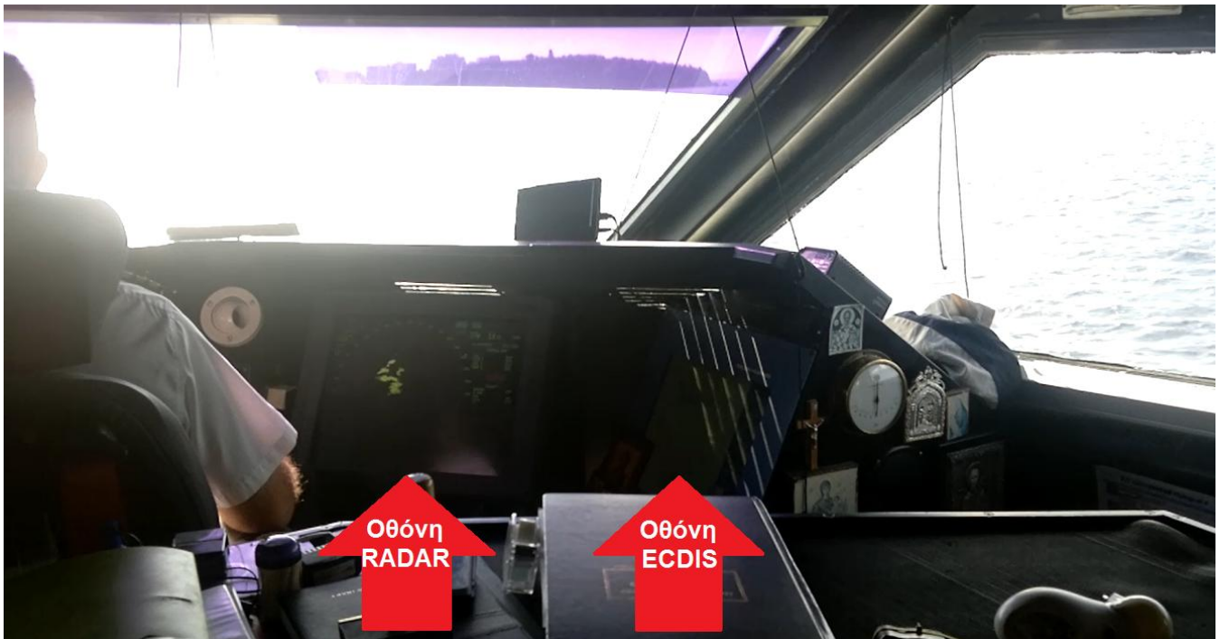
Εικόνα 4.2.1/ 2: Η θέση των οθονών των συσκευών RADAR και ECDIS στην πλευρά της δεξιάς θέσης (θέση “MASTER”) στη γέφυρα του πλοίου, σε σχέση με τον Αξιωματικό Γέφυρας που καθόταν στη θέση αυτή.
