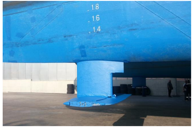
Εικόνες 3.7/ 1 & 2: Το αριστερό πτερύγιο ζυγοστάθμισης του σκάφους πριν και μετά τις εργασίες προσωρινής αποκατάστασης της ζημιάς του σε ναυπηγείο στο Πέραμα (Φωτογραφίες από Κ.Ε.Ε.Π./Δ.Ε.Π.)
